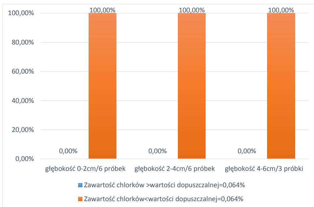
Rys. 6 Zawartości procentowe chlorków, próbki pobierane na rzędnej +1,50A
