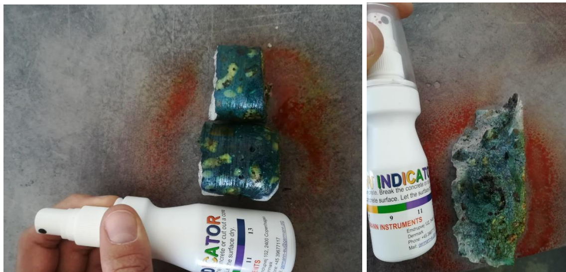
Fot. 2,3. Pomiar karbonatyzacji z użyciem wskaźnika Rainbow Indicator
